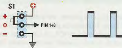
Fig.6 Spostando le levette numerate da 1 a 8 verso il segno + , in uscita si ottengono 2 impulsi Stretti . Nella fig.3 risultano spostate sul + le levette da 1 a 4.
