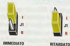
Fig.9 Se inserite lo spinotto femmina sui due terminali di J1 posti in alto, avrete un'azione del relè Immediata , se invece lo inserite sui due terminali posti in basso, avrete un'azione del relè Ritardata .
