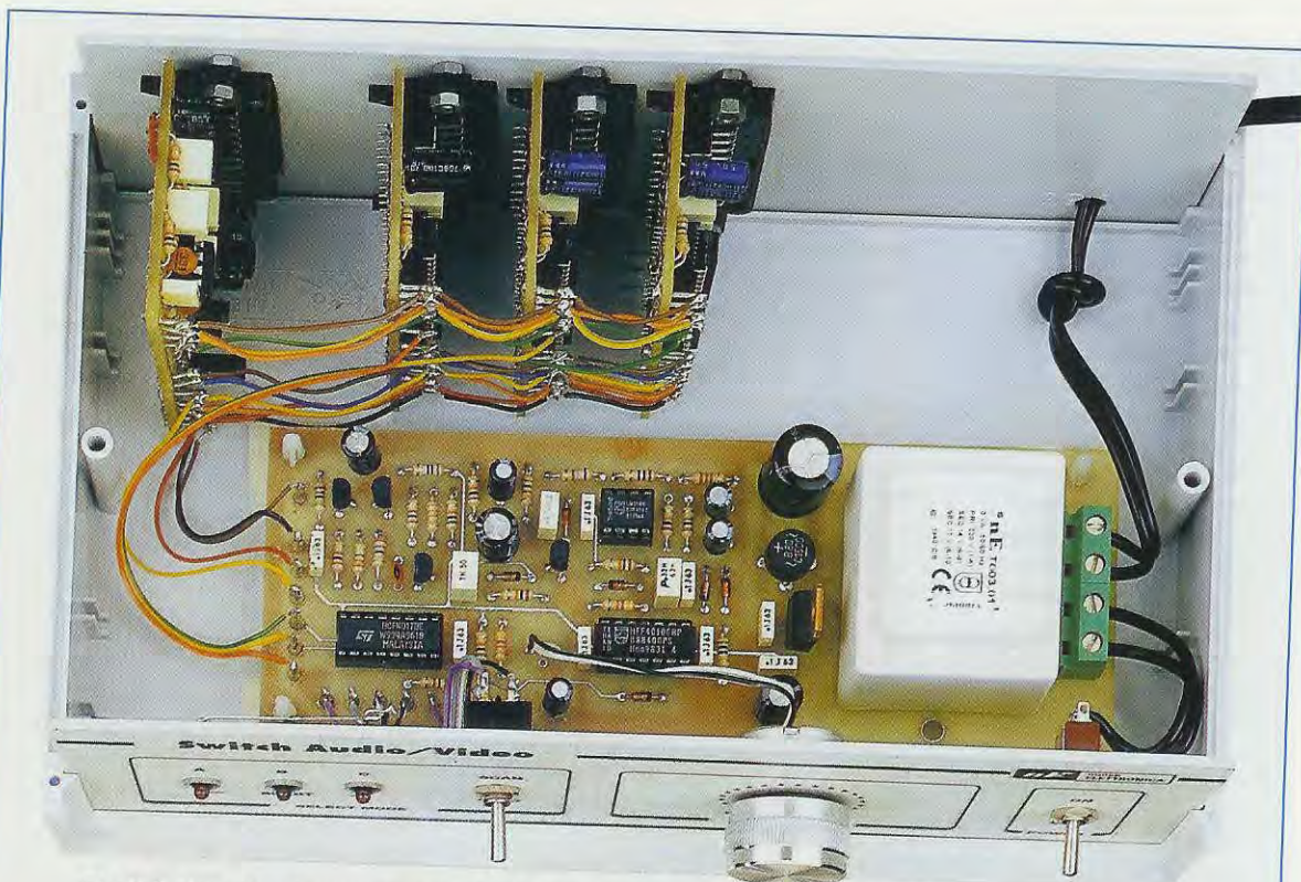
Fig.9 Il circuito stampato base LX.1503 visibile in fig.12 viene fissato sul piano del mobile plastico con 4 distanziatori plastici provvisti di base autoadesiva, mentre i circuiti stampati delle prese A-B-C e OUT/IN vengono fissati sul pannello posteriore.
