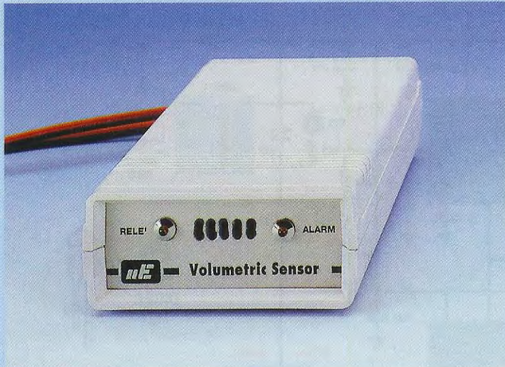
Fig.5 Le piccole fessure presenti sul pannello frontale del mobile servono per lasciar passare verso il microfono tutte le variazioni di pressione dell'aria.
