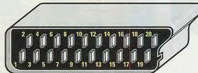
Fig.5 Connessioni della presa scart Maschio viste frontalmente. Il terminale 1 è il primo posto in basso a sinistra, mentre il terminale 19 è l'ultimo posto in basso sulla destra.
