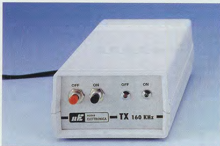
Fig.1 In basso a sinistra, potete vedere il circuito stampato dello stadio trasmettente TX già fissato all'interno del suo mobile e nella foto qui di lato il pannello frontale con i due pulsanti OFF e ON e i diodi led di controllo.
