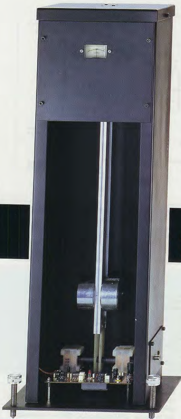
Fig.1 Nella foto sopra il sensore con pendolo verticale siglato LX.1358 (vedi rivista N.195), e nella foto di sinistra il mobile utilizzato per l'interfaccia LX.1500 che vi servirà per visualizzare i sismogrammi dei terremoti sul monitor di un computer.
