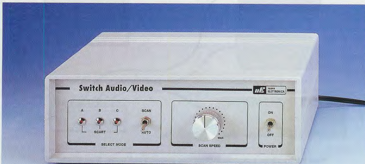
Fig.1 Foto del mobile utilizzato per questo commutatore automatico in grado di prelevare il segnale Audio-Video da 3 diverse prese Scart per indirizzarlo su un'unica uscita e viceversa. La manopola serve per variare la velocità di scansione e i 3 diodi led A-B-C per segnalare da quale delle tre prese Scart A-B-C si preleva o si indirizza il segnale Audio-Video.
