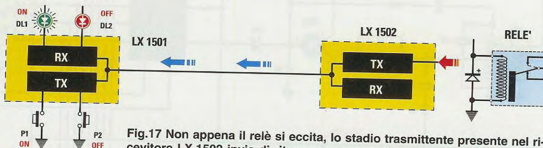
Fig.16 Quando nello stadio trasmettente LX.1501 premiamo il pulsante P1 - ON, sulla linea della tensione di rete dei 220 volt viene inviata una serie di impulsi codificati (vedi figg.3-9) che, captati dallo stadio ricevente LX.1502, provvederanno ad eccitare il suo relè.
