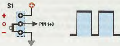
Fig.7 Spostando le levette numerate da 1 a 8 verso il segno - , in uscita si ottengono 2 impulsi Larghi . Nella fig.3 risultano spostate sul - le levette da 5 a 8.
